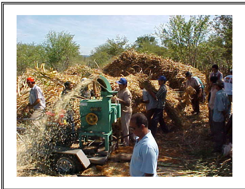
Figura 30: Redução da forragem com auxílio da máquina ensiladeira – Comunidade Baixa da Umburanas.
