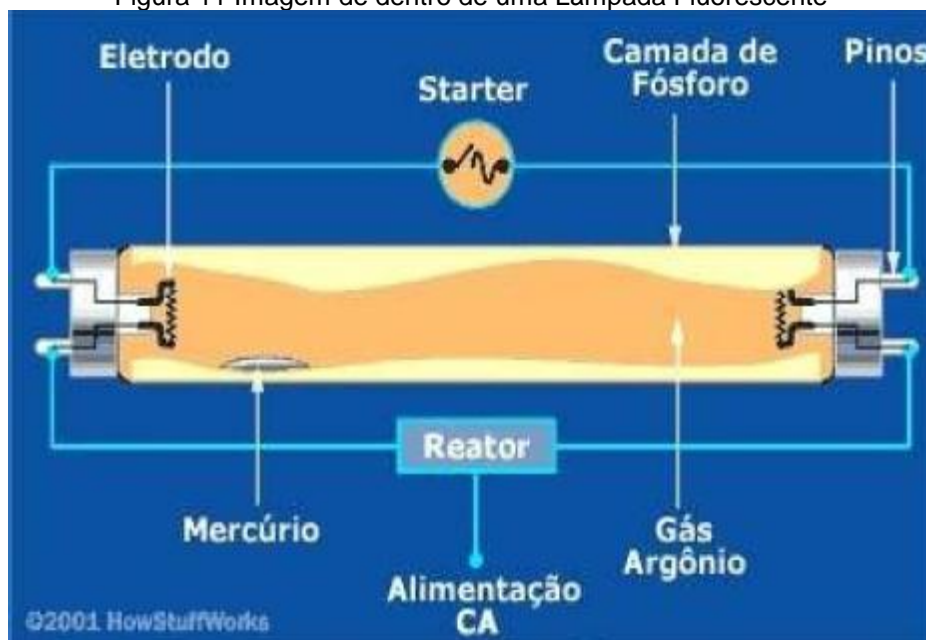
Figura 11 Imagem de dentro de uma Lâmpada Fluorescente
