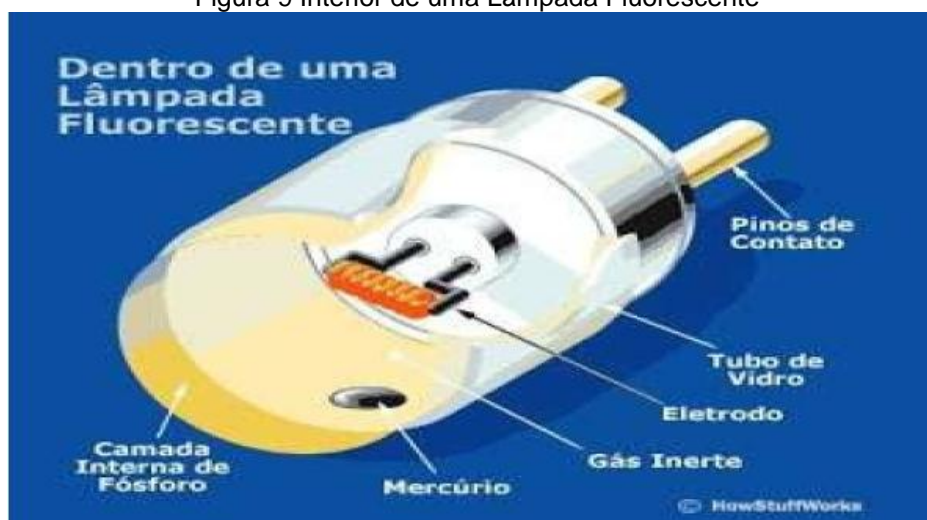
Figura 9 Interior de uma Lâmpada Fluorescente
