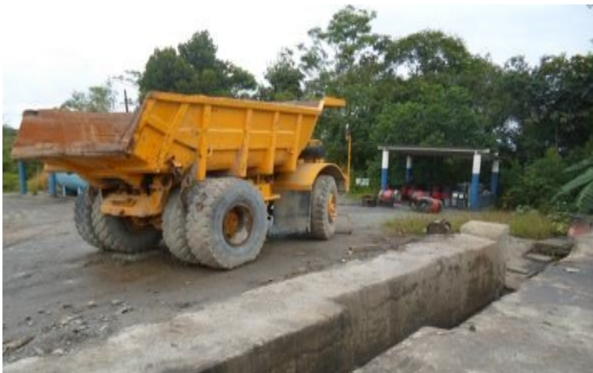
Figura 49 - Rampa para lubrificação e troca de óleo das máquinas e equipamentos
