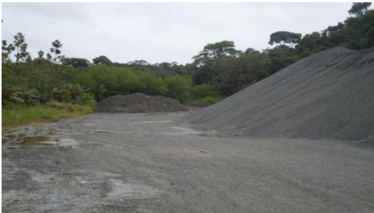
Figura 43 - Pilha de rejeitos (estéril) depositados próximo ao pátio de estocagem
