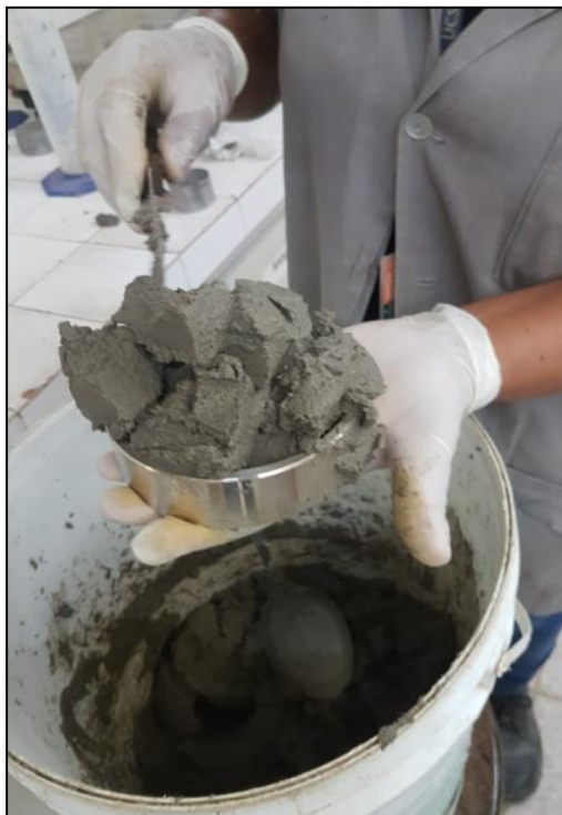
Figura 4 – Adição dos últimos incrementos de argamassa para rasamento
