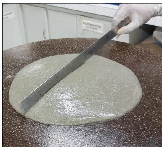
Figura 2 – Aferição do espalhamento do cone tronco-cônico após os golpes.
