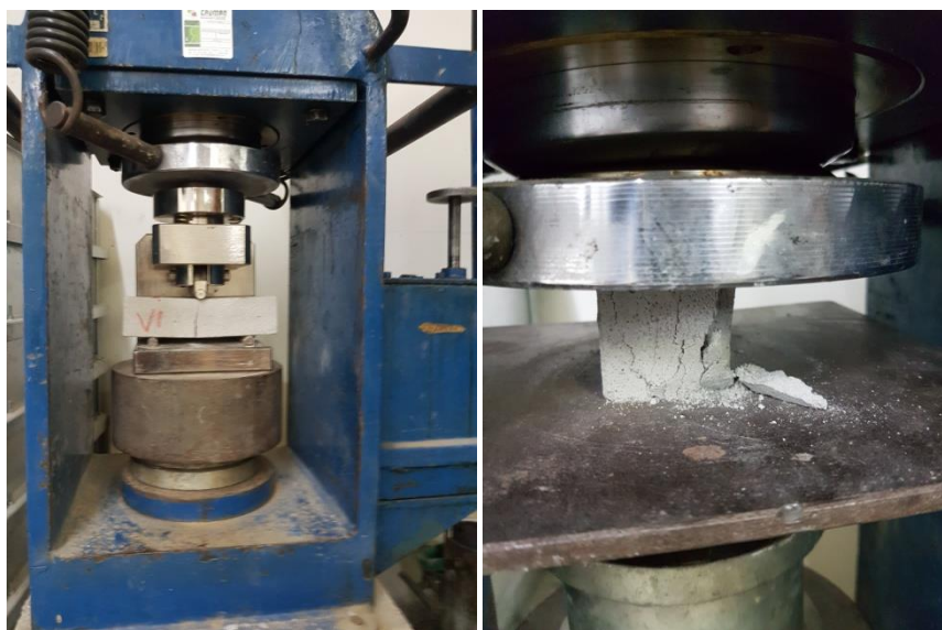
Figuras 10 e 11 – Forma de ruptura dos corpos de prova submetidos à tração na flexão e à compressão, respectivamente
