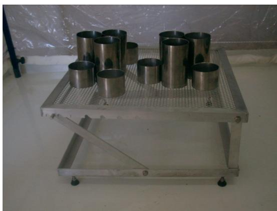
Figura 2 – Mesa ajustável, coletores de chuva e recipientes para ensaio de perda por “Splash”.
