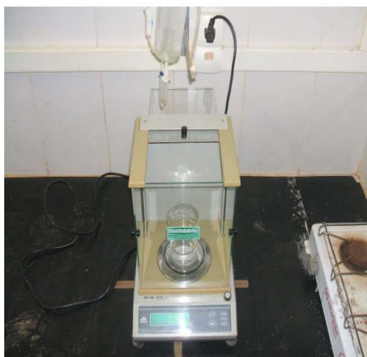
Figura 1 – Equipamento utilizado para obter a massa da gota a partir de agulhas hipodérmicas
