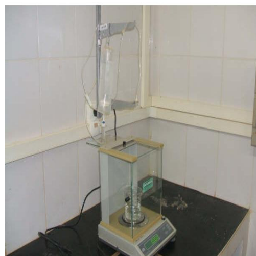
Figura 1 – Equipamento utilizado para obter a massa da gota a partir de agulhas hipodérmicas
