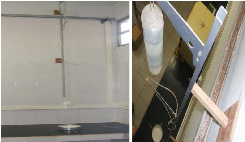
Figura 3 – Equipamento utilizado para determinar a massa e o diâmetro dos grânulos.
