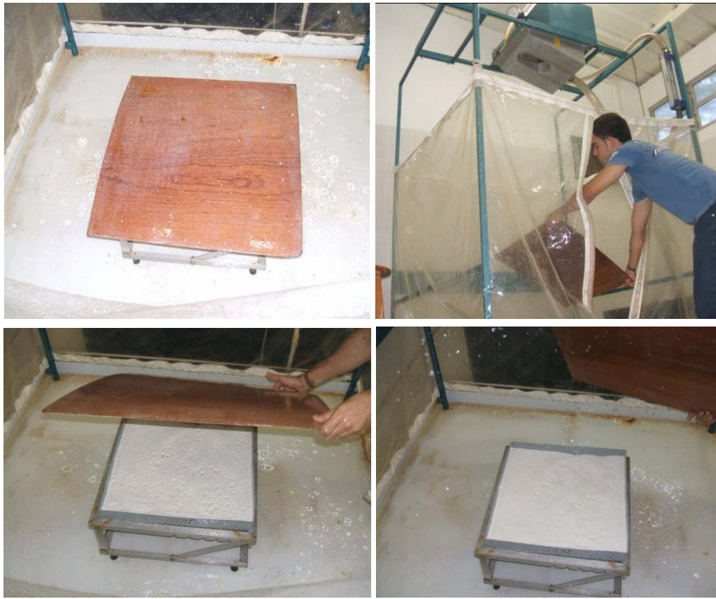
Figura 4 – Ensaio com o simulador de chuvas empregando o método da farinha.
