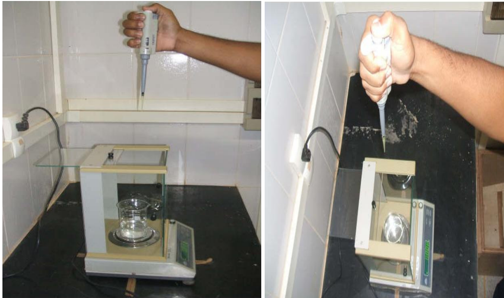
Figura 2 – Equipamento utilizado para obter a massa da gota a partir de uma micropipeta
