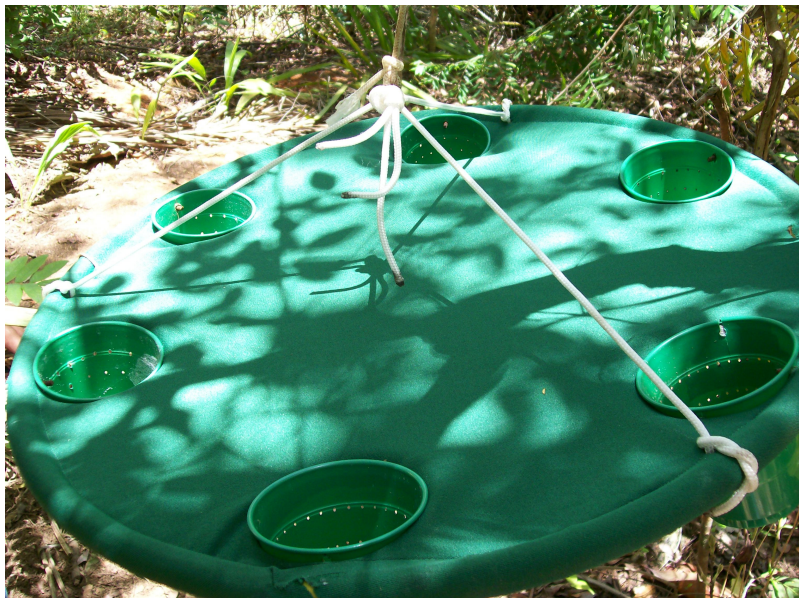
Figura 2. Estrutura basal da armadilha aérea de captura, desenvolvida para coleta de aranhas em copas.
