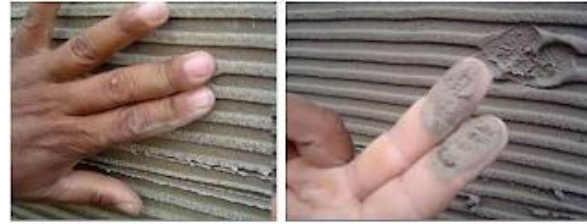
Argamassa apta para uso
