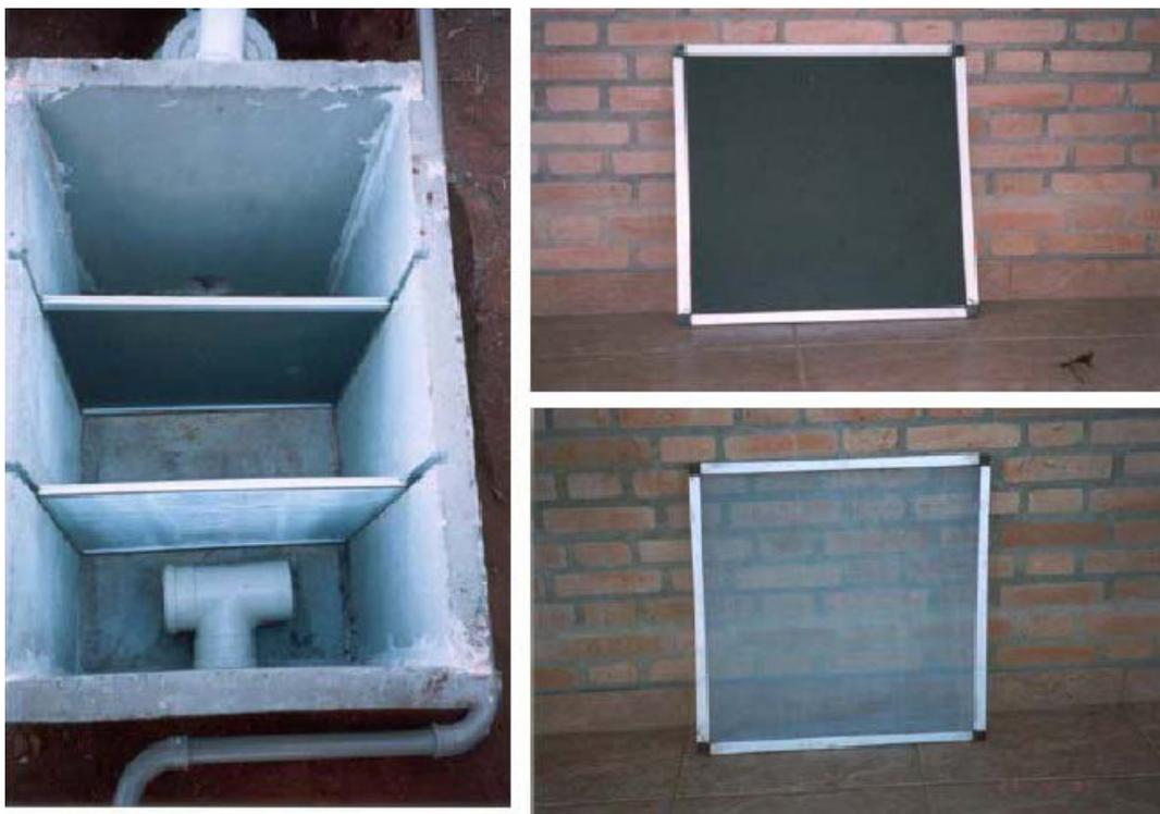
Figura 6 - Dispositivo de retenção de partículas sólidas composto por uma malha metálica (abertura 0,83 mm, fio 0,23 mm) para retenção de detritos maiores e uma manta de geotêxtil com gramatura de 130 g/m<sup>2</sup>, para retenção de finos (AMORIM, CAMPOS & HERNANDES, 2004)
