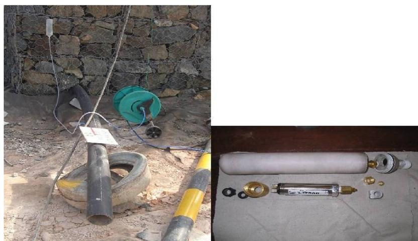
Figura 9 – Entrada do tubo de PEAD e sonda com o transdutor de pressão
