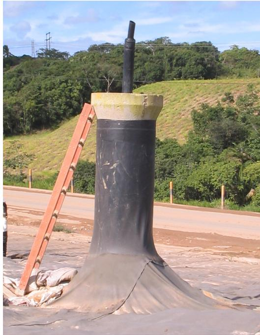
Figura 03 – Piezômetro tipo Vector instalado no Aterro Metropolitano Centro para monitoramento do nível de chorume.
