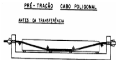
Figura 6 – Desviadores para permitir mudança de direção dos cabos utilizados na pré-tração para configuração poligonal.
