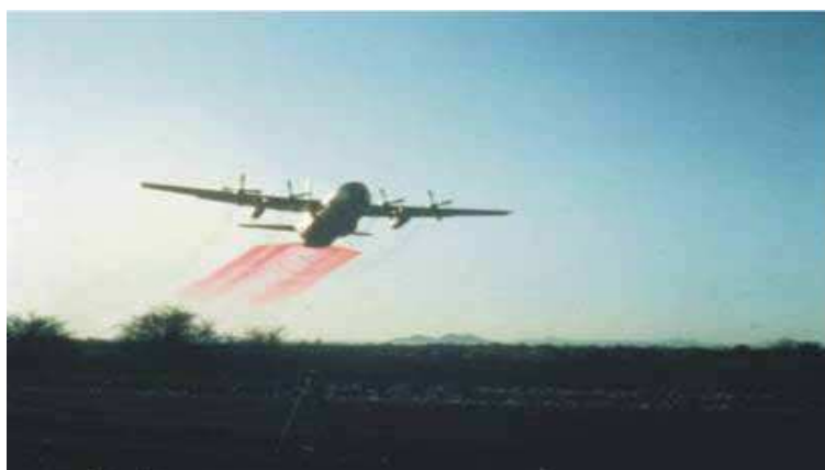
Figura 36 – Lançamento de dispersante por avião Fonte: Associação Regional de Empresas de Óleo e Gás Natural da América Latina e Caribe (2007)
