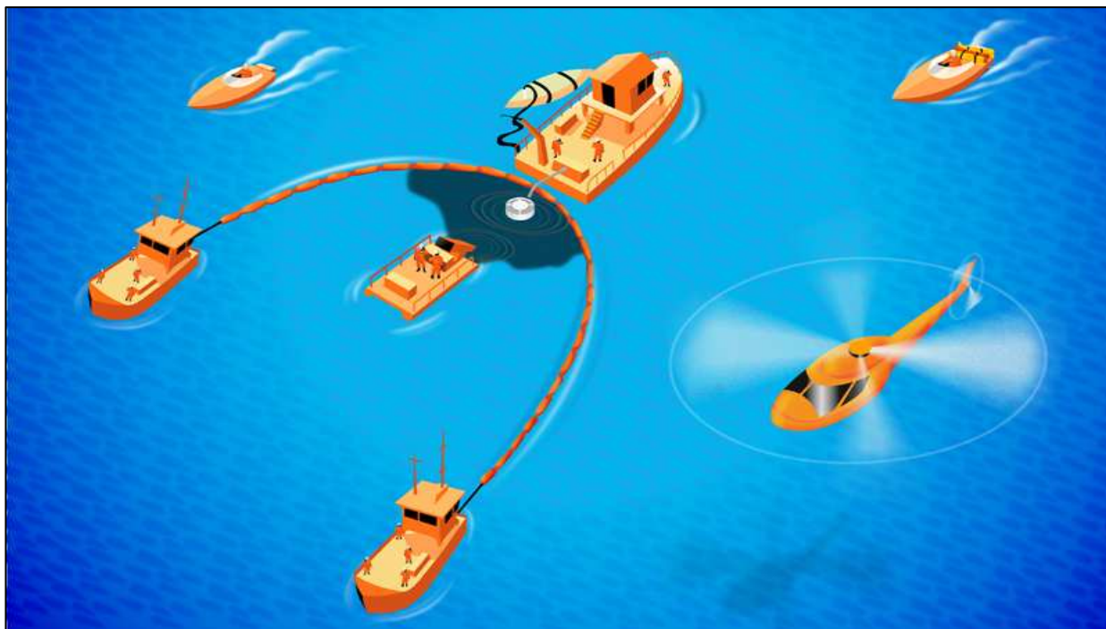
Figura 42 – Operação de contenção e recolhimento de óleo derramado na água Fonte: Petrobras (2008c)
