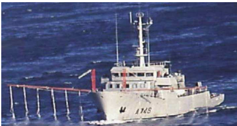
Figura 35 – Lançamento de dispersante por embarcação Fonte: International Maritime Organization (2005)
