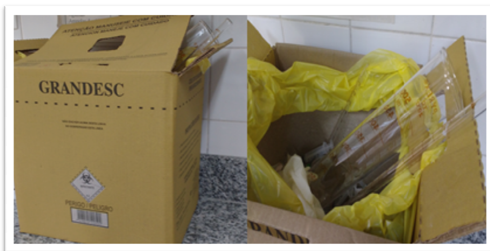
FIGURA 8: Caixa de material perfurocortante fora de especificação
