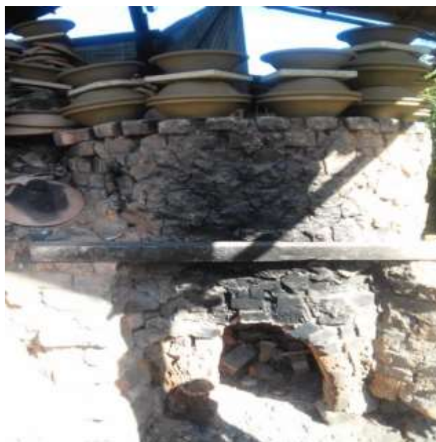
Figura 22: Forno usado na queima da cerâmica em Maragogipinho. 2018. Fonte: Acervo da autora,
