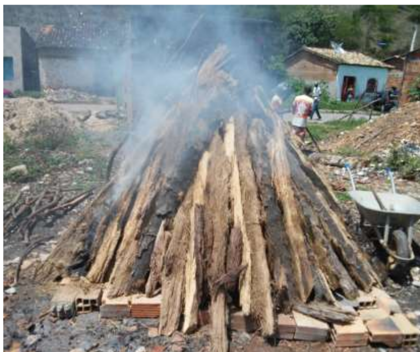
Figura 25: Início do processo da queima dos objetos de cerâmica em Coqueiros. 2018. Fonte: Acervo da autora.
