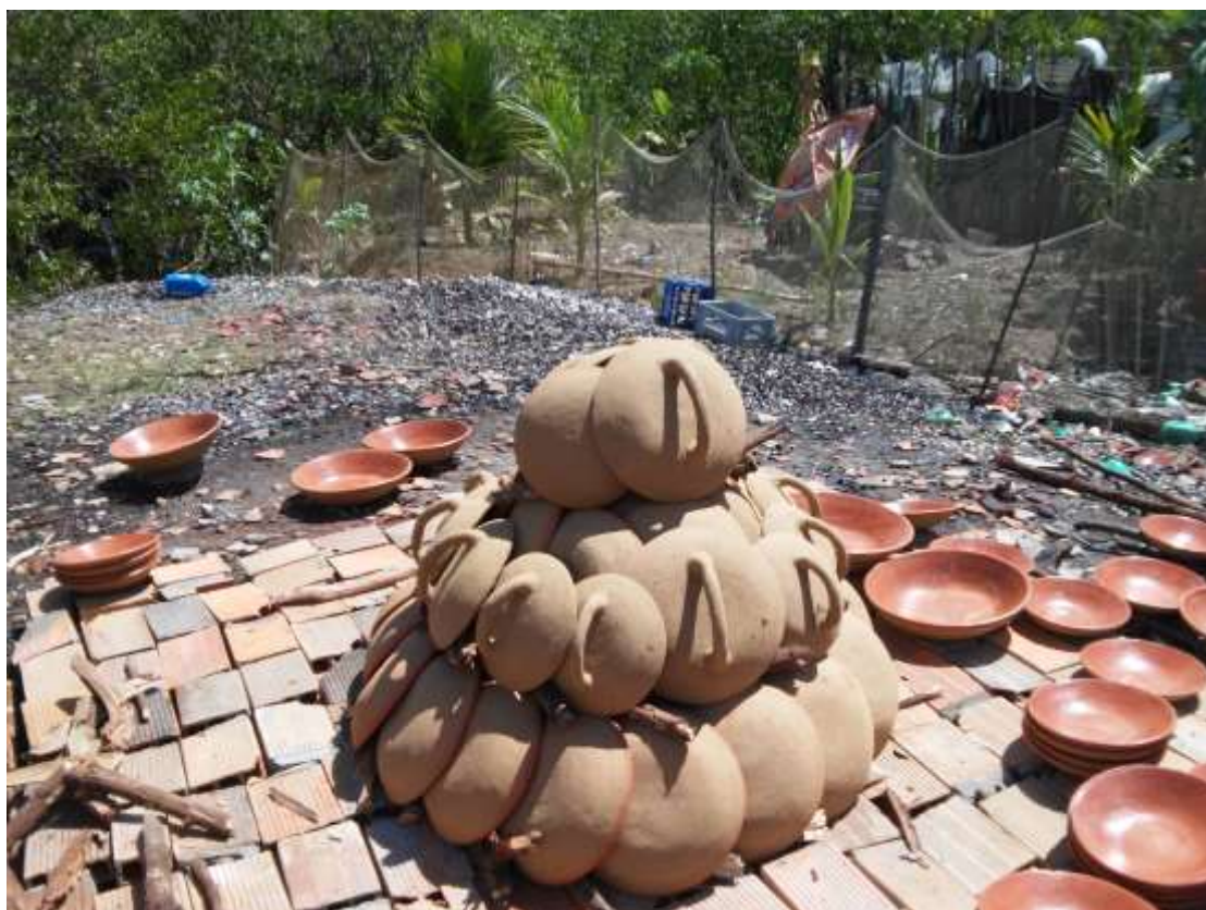
Figura 12: Início do processo de queima das peças de barro em Coqueiros. 2018. Fonte: Acervo Pessoal.
