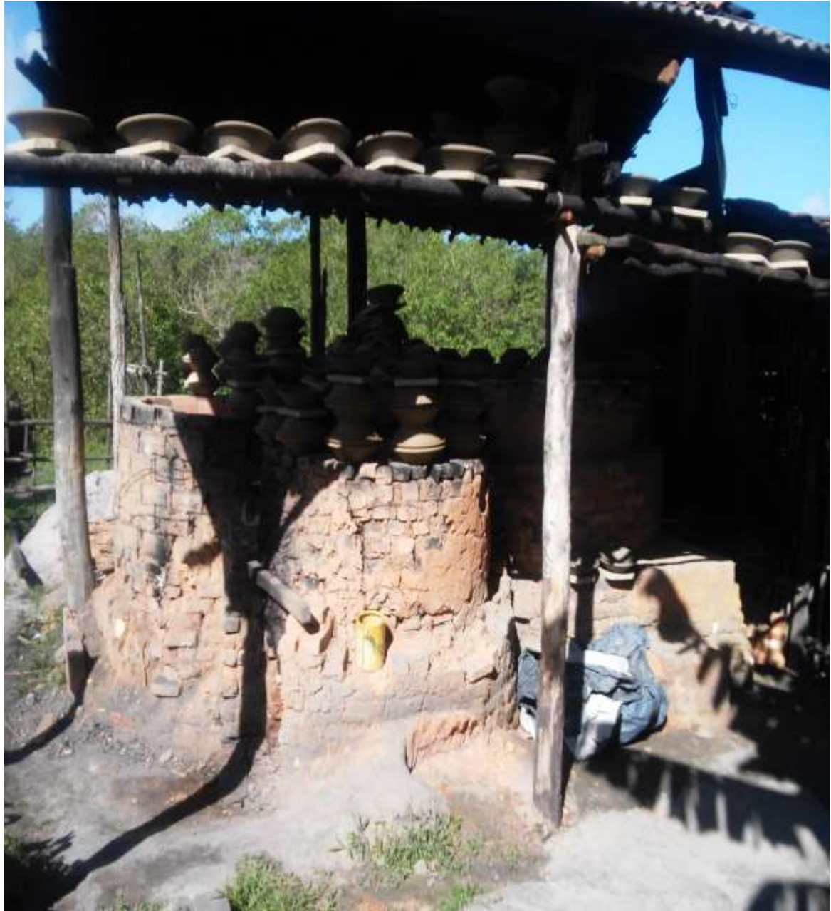
Figura 10: Forno para queima das peças de cerâmica em Maragogipinho. Fonte: Acervo da autora. 2018.
