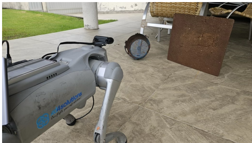
Figura 34 – Cenário de teste com chapas metálicas corroídas
