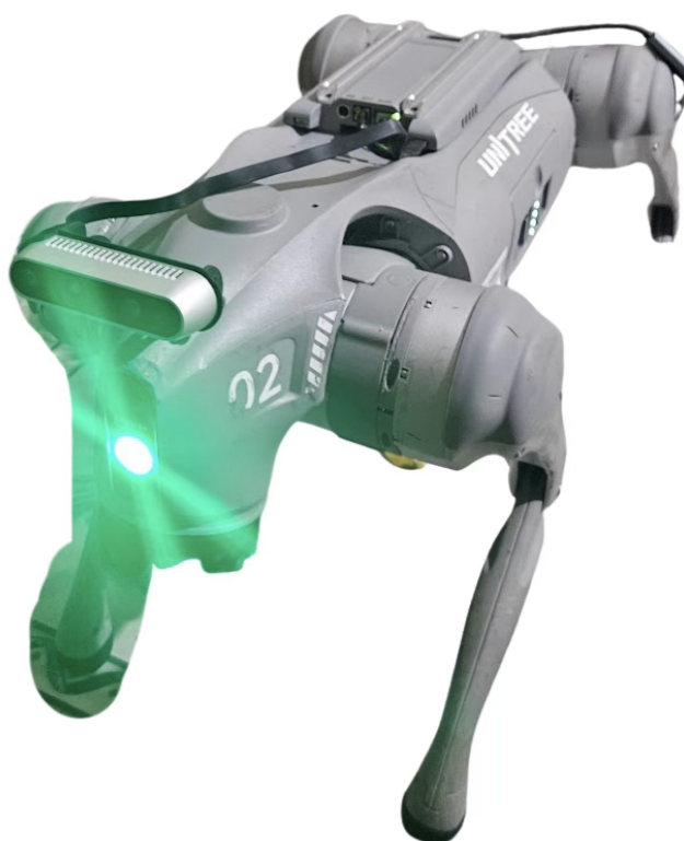
Figura 14 – Protótipo físico do robô Go2 instrumentado
